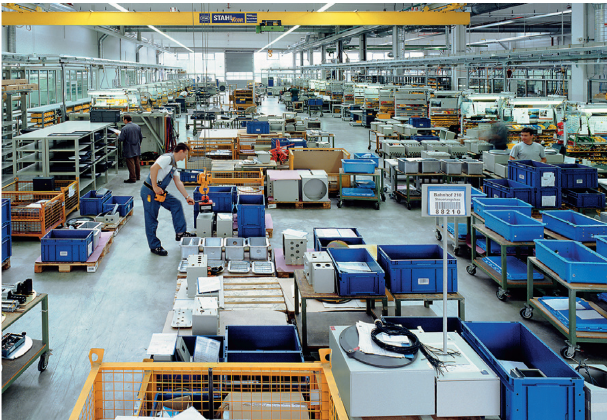
Flexible Fertigungsline im Steuerungsbaue am Standort Waldenburg. Im Bildabschnitt rechts hinten zu sehen: dickwandige Gehäuse in der Ausführung „Ex d“.
